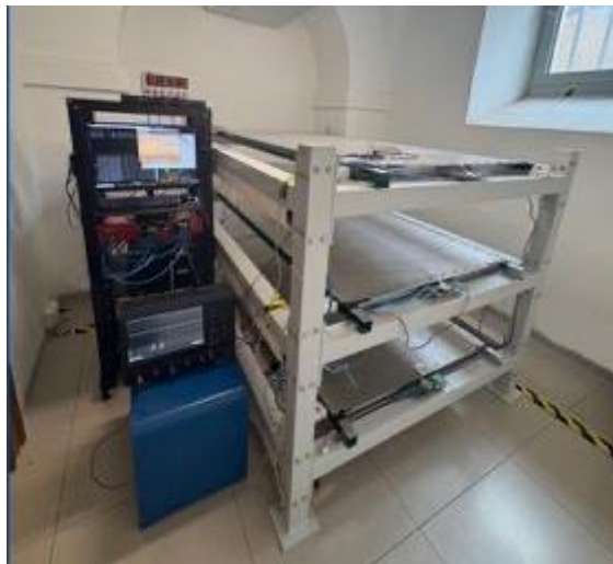
Il laboratorio del Progetto EEE al CREF: visibile la struttura meccanica di sostegno dei tre rivelatori MRPC, i due PC per la gestione del funzionamento del rivelatore ed un oscilloscopio per controlli.
