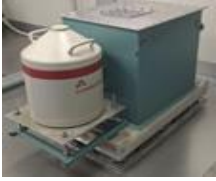
Figura - Nuovo setup basato su rivelatore Broad Energy Germanium (BEGe). Il setup è supportato da sospensioni meccaniche per minimizzare le vibrazioni meccaniche. Un soundproof box minimizza le vibrazioni acustiche ed agisce da gabbia di Faraday
